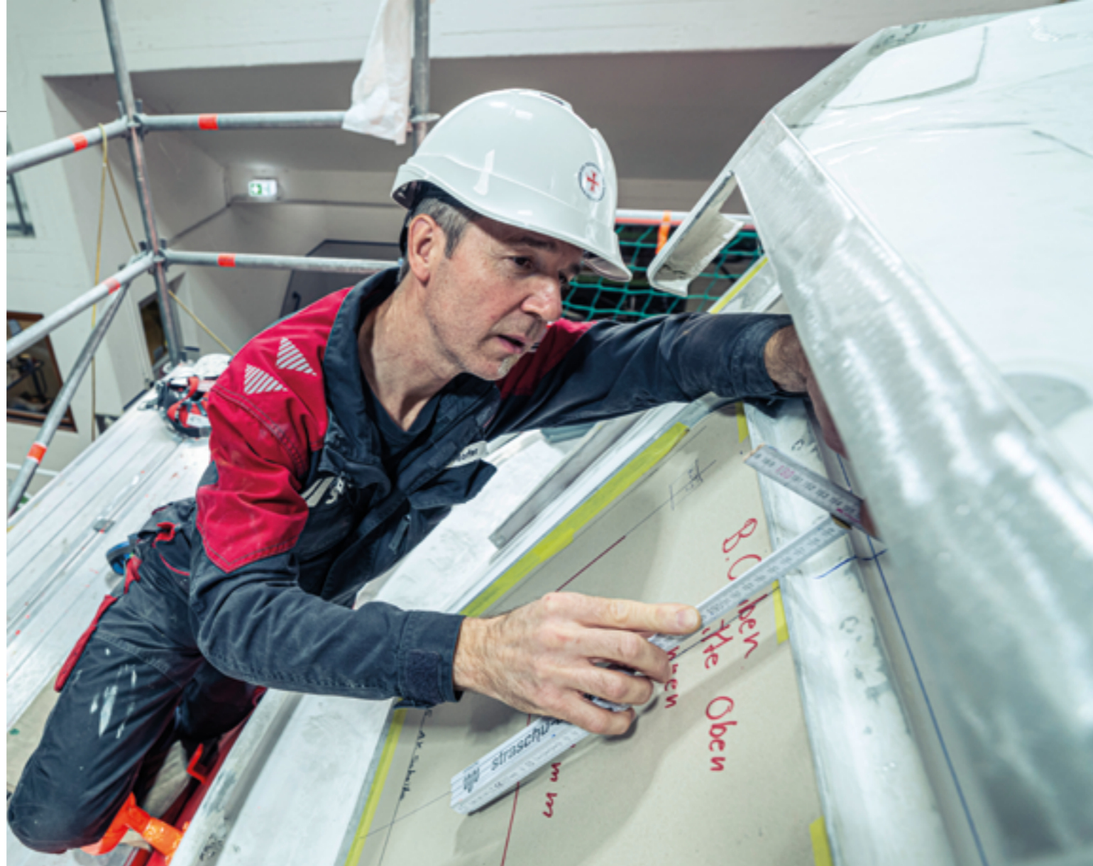
Maschinenschlosser Stefan Neundorfer nimmt an der Brücke Maß für die Befestigungen der neuen Hochleistungsscheibenwischer, die er später anbauen wird.
